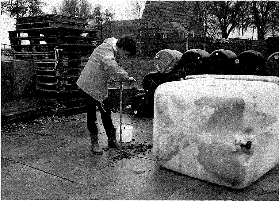
Afb. 5.12. Op een opslagplaats van chemisch afval, waar lekkende vaten werden aangetroffen, worden bodemonsters genomen om de mate van bodemverontreiniging vast te stellen.
