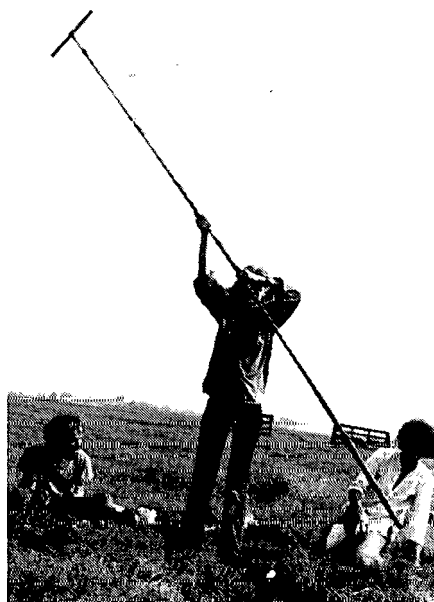
Boren in het veengebied. Er werd geboord tot 3,5 m diepte. Een gaslucht kwam uit het boorgat omhoog. Opleiding Leraren Basisonderwijs, Beverwijk 1982
