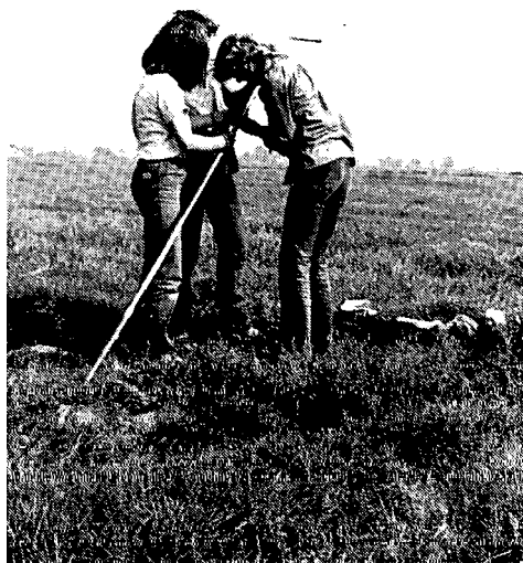
Boren in het veengebied. Er werd geboord tot 3,5 m diepte. Een gaslucht kwam uit het boorgat omhoog. Opleiding Leraren Basisonderwijs, Beverwijk 1982
